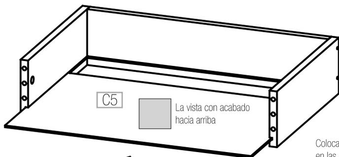
Coloca el fondo del cajón insertándolo en las ranuras y deslizándolo hasta que tope. PIEZA C5
