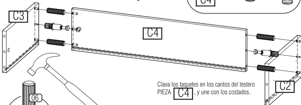
Clava los taquetes en los cantos del testero PIEZA C4, y une con los costados.
