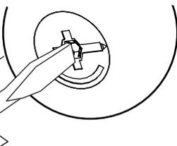
Coloca los minifix como se muestra. Posteriormente coloca el fondo del cajón insertándolo en las ranuras y deslizándolo hasta que tope. PIEZA C5
